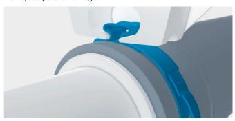
Para uma montagem correta, posicione as garras do alicate na "orelha" da abraçadeira. Feche as garras do alicate para comprimir a orelha da abraçadeira. Isto reduz o diâmetro da abraçadeira de orelha ToothLock®. A ferramenta pode ser retirada uma vez que as garras do alicate abrirem depois que a orelha estiver fixada.
