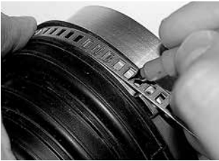
步骤 2 确定卡箍条带长度。
